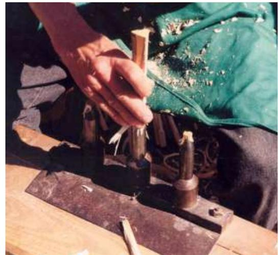
Abbildung 1 Rechenzähne Herstellung mit Schlageisen
